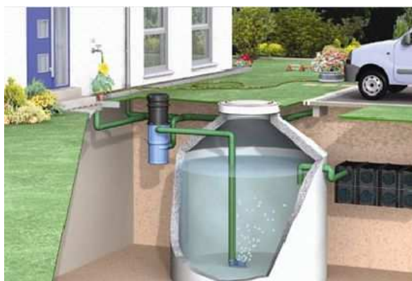
Figura 19: Esquema de instalação do tubo de alimentação Fonte: 3P Technik (2011)
