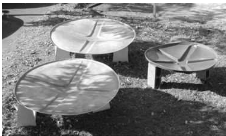
Figura 47: Aparato experimental para coleta de chuva da atmosfera Fonte: Arquivo pessoal do autor
