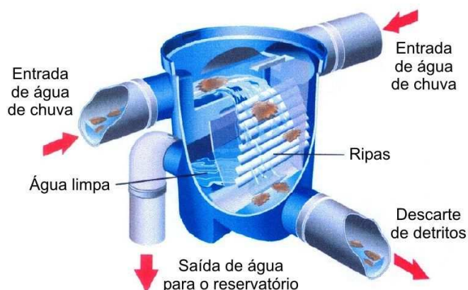
Figura 14: Dispositivo de primeira lavagem e descarte de sólidos grosseiros Fonte: 3P Technik (2011)
