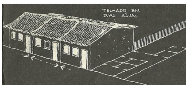
a) Telhado duas águas
