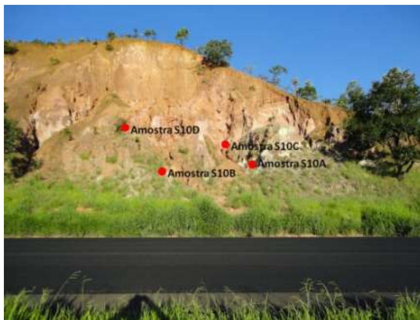
Figura 5.3 :Erosão no Km 128 onde foram coletadas as amostras dos solos S10A, S10B, S10C e S10D.
