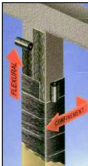
Figura 7 - Reforço de pilares. Fonte: ABCP (2009).
