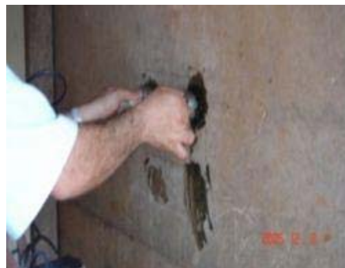
Realização do ensaio de ultra-sonografia – edifício “A”.
