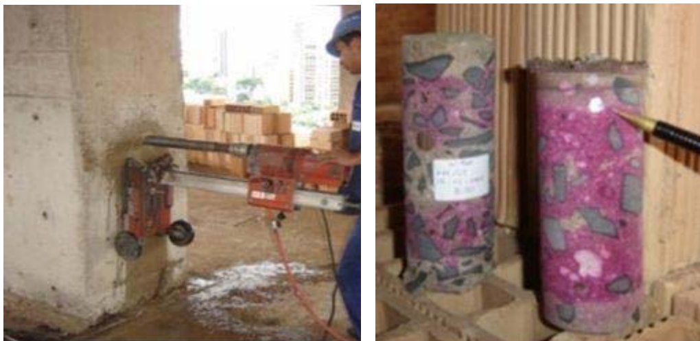
Figura 2.2 – Extração de testemunhos.
