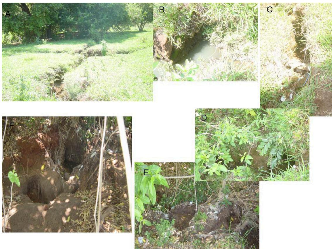
Figura 5.13: A seqüência de letras mostra o caminho percorrido pelas águas. A- ravina na área gramada; B- água empocada em pequena voçoroca ainda na parte gramada; C- ravina em área de declive, perto do maciço arbóreo; D- ravina no começo do maciço arbóreo; E- ravina dentro do maciço arbóreo; F- pequenas voçorocas formadas dentro da mata ciliar.
