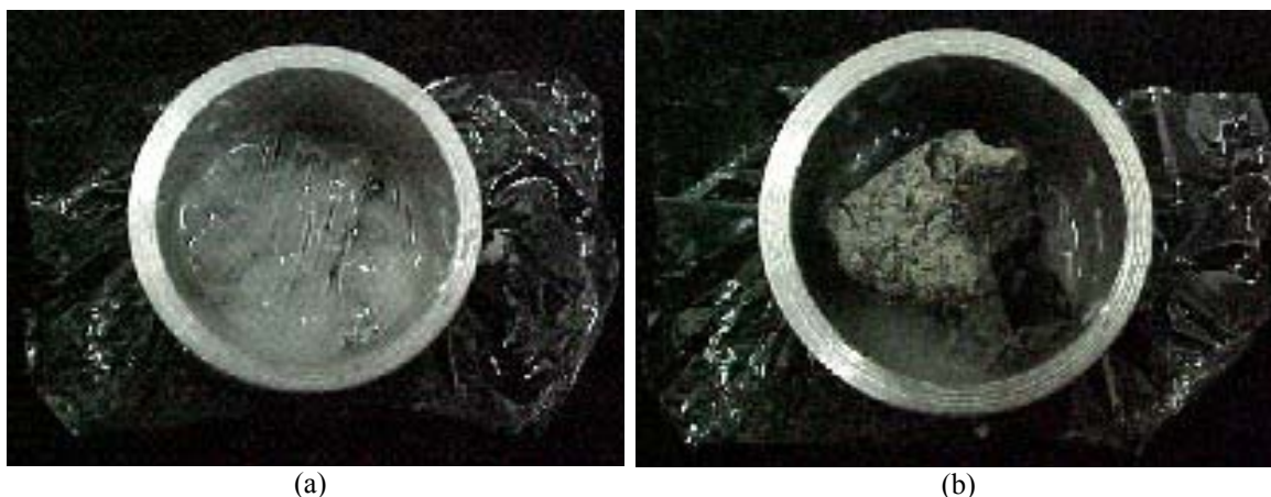
Figura 4.13 – Posicionamento da amostra; a) Camada base, b) Inserção da amostra.
