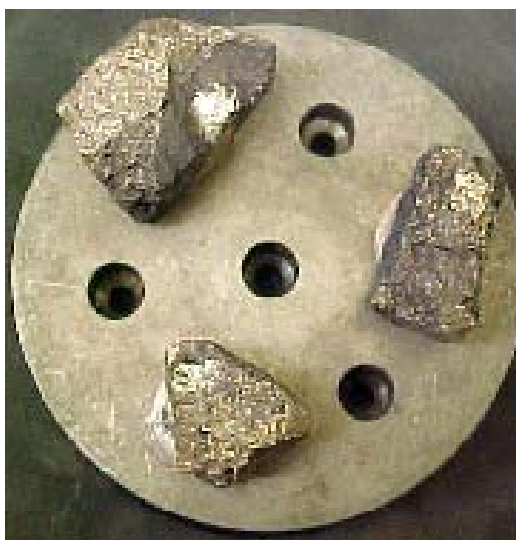
Figura 4.9 – Amostras metalizadas e fixadas na haste.
