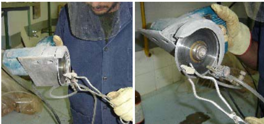
Figura 4.4 – Refinamento geométrico das amostras.
