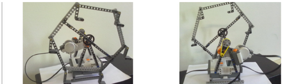
FIGURA 47 – Roda-gigante. Vista frontal (esquerda) e traseira (direita), onde se pode ver o sensor que inicia o movimento
