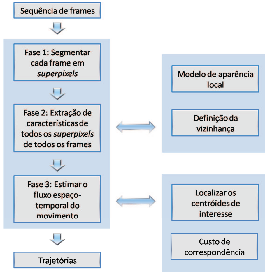
Figura 4.6: Fases do processo de identificação de trajetórias espaço-temporais de movimento em vídeos.
