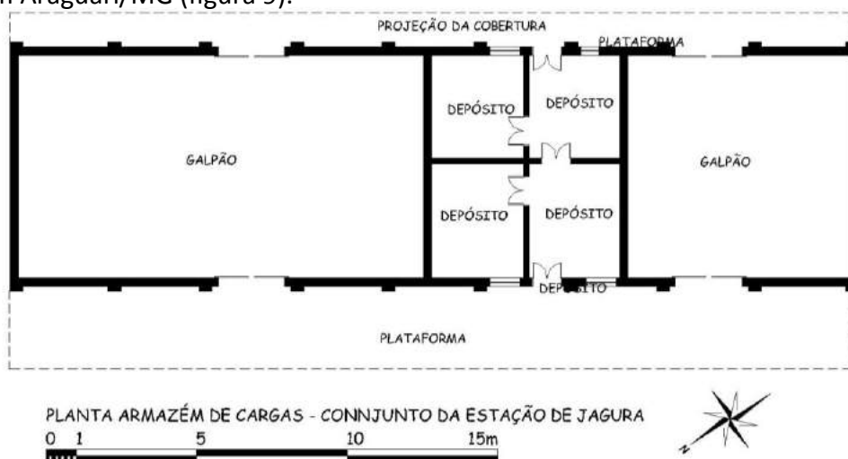
Figura 7 - Planta do armazém de cargas do conjunto da Estação da Jaguará em Sacramento/MG. Nota-se o espaço de armazenagem e depósito.
