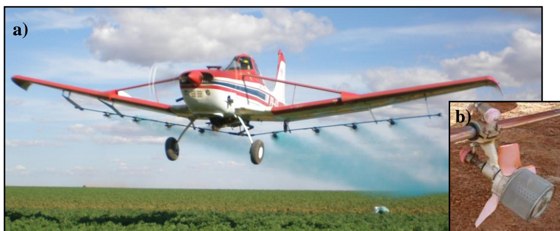
FIGURA 3. a) Aeronave agrícola AG TRUCK - 300 utilizada nas aplicações. b) Atomizador rotativo Micronair AU 5000. Perdizes – MG, 2009.
