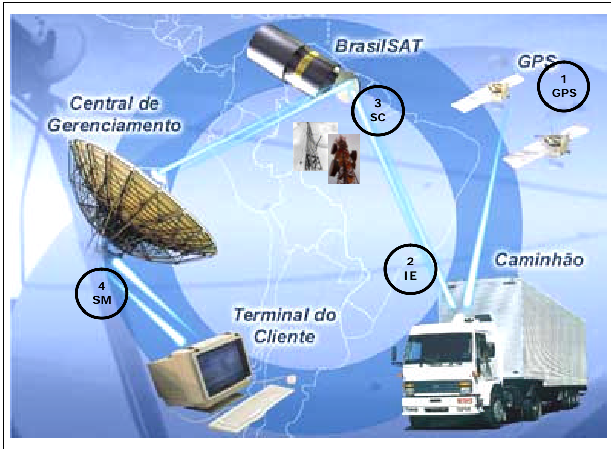
Figura 6 – Sistema de rastreamento de veículos e de cargas. Fonte: Adaptado de Autotrac (2007).
