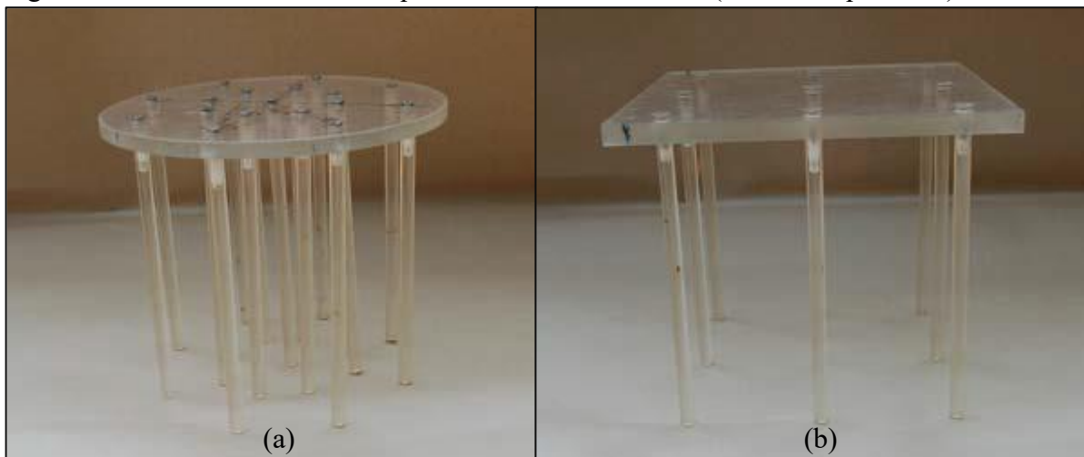
Figura 16 - Modelo de radier estaqueado em escala reduzida (circular e quadrado).
