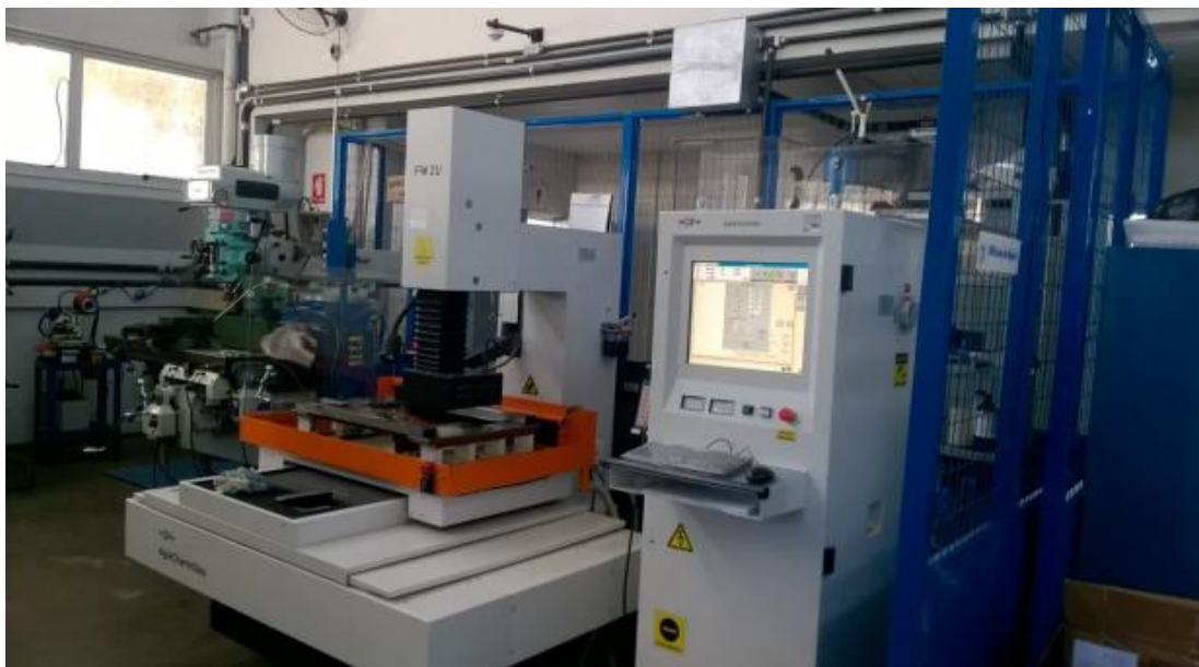
Figura 12 - Máquina GF AgieCharmilles FW 2U instalada no LTAD e utilizada para a confecção dos corpos de prova do mini charpy.
