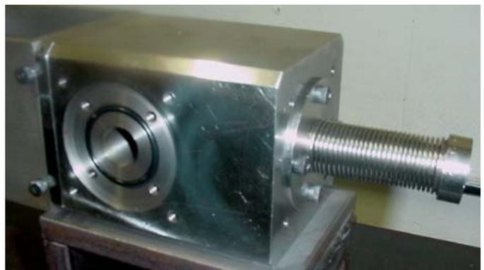
Figura 3.6 - O obturador da válvula e os elementos de vedação do sistema hidráulico.
