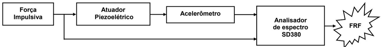
Figura 7.16 – Fluxograma da instrumental do ensaio a malha aberta para obtenção da resposta em frequência do atuador piezoelétrico.
