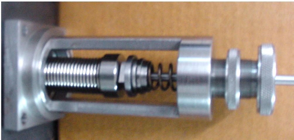
Figura 3.4 - Sistema fixação do fole flexível à sede da válvula construído.
